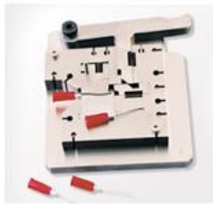
Fig. 4: exemplo de peças fabricadas por Eletro Erosão a Fio (fonte: www.advanced-edm.com )
