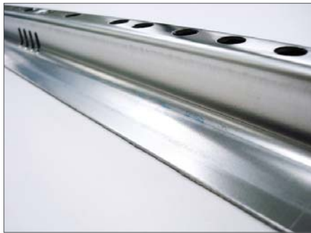
■ Ferramenta COM DUROTIN® Duplex após 150.000 peças estampadas
