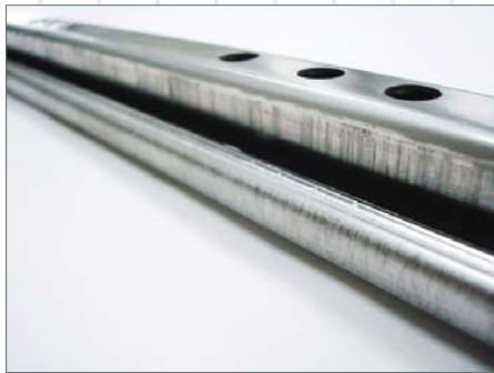
■ Ferramenta SEM DUROTIN® Duplex após 5.000 peças estampadas
